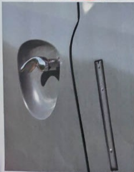
Die zugekauften Türgriffe sind strömungsgünstig versenkt. Der Serien-VW erhielt flachere Öffner
