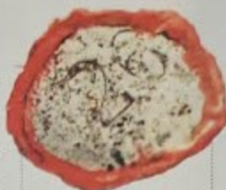
Nach dem Sandstrahlen wurde diese 26 sichtbar. Mit an Sicherheit grenzender Wahrscheinlichkeit ist es die Seriennummer
